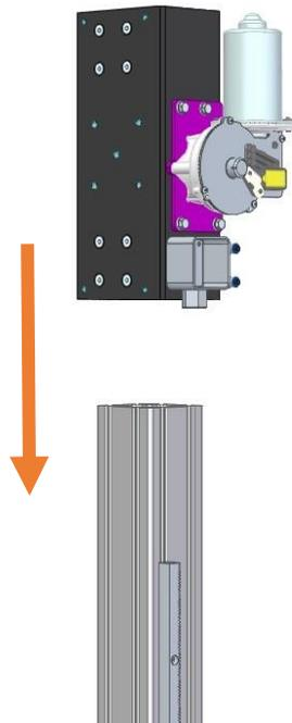
Schieben Sie die Gleitplatte mit den sich auf der Rückseite befindenden Gleitern von oben in das Profil.
