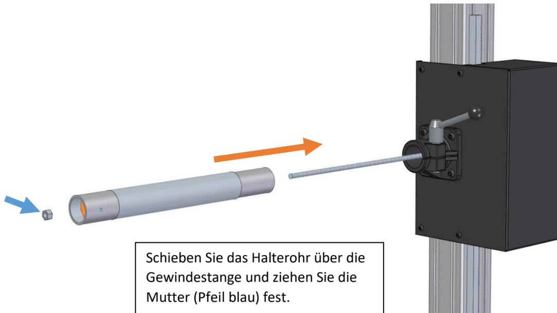
Schieben Sie das Halterrohr über die Gewindestange und ziehen Sie die Mutter (Pfeil blau) fest.
